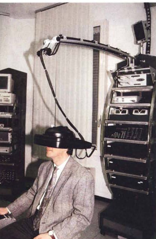
Il Datavisor della n-Vision è un HMD a CRT miniaturizzati posti ai lati delle tempie. L'immagine è diretta verso gli occhi attraverso un treno di lenti e specchi. La tecnologia adottata per il tracciamento dei movimenti è quella elettromagnetica Fastrak. Si nota infatti nella seconda foto un particolare della centralina di controllo del casco e sotto quella del Polhemus Fastrak.
